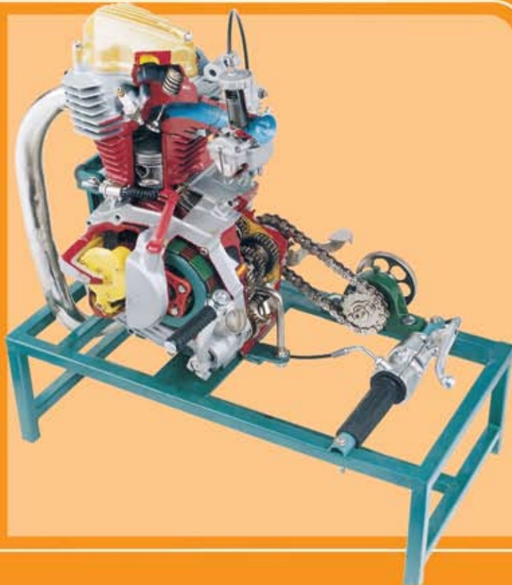
مقطع محرك رباعي الدورة ١٢٥ سي سي أحادي الاسطوانة
