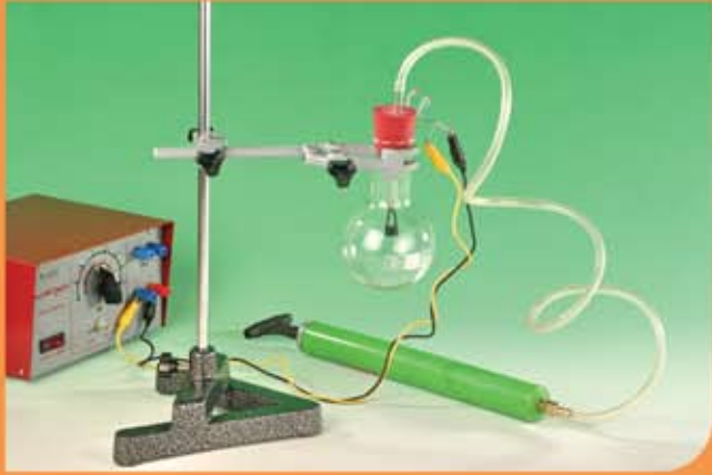
جهاز تشخيص عدم انتشار الصوت في الفراغ
